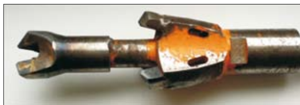
Рисунок 2 – Серийная буровая коронка после изменения диаметра резания и углов заточки резцов
