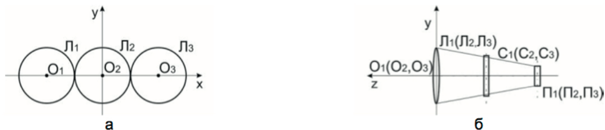
O_1, O_2, O_3 – центры входных зрачков; L_1, L_2, L_3 – входные зрачки объективов каналов прибора; C_1, C_2, C_3 – светофильтры; P_1, P_2, P_3 – приёмники излучения
