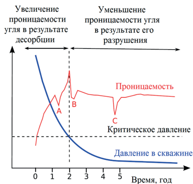
Рисунок 5 - Схематичное обозначение изменения проницаемости угля в окрестности скважины и давления газа в ней (по данным [13])
