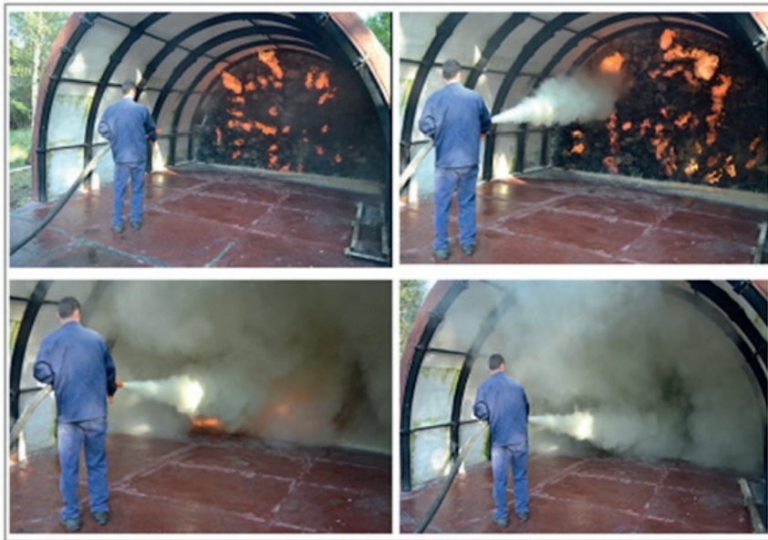
Рисунок 6 - Процесс объемного тушения горящего метана модулем ИМОП Figure 6 - The process of volumetric extinguishing of burning methane by the IMOP module
