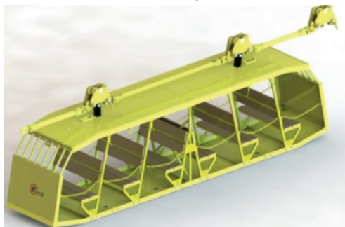
Рисунок 10 – Транспортная монорельсовая кабина для перевозки персонала Figure 10 - Transport monorail cabin for the transportation of personnel
