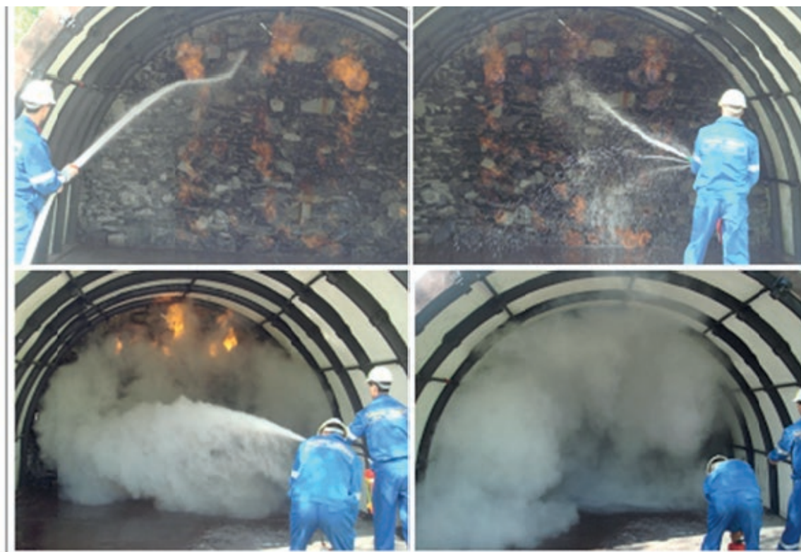
Рисунок 2 – Использование водяных, пенных (верхние фрагменты) и порошковых средств тушения метана в опытном штреке Figure 2 - Use of water, foam (upper fragments) and powder methane quenching means in an experimental drift
