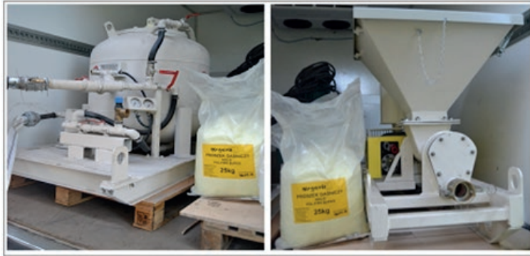
Рисунок 5 – Пневматический MARS-Z1 (слева), гидравлический MARS-H (справа) осланцеватели, а также огнетушащий порошок для тушения пожаров класса А, В, С-Е Figure 5 - Pneumatic MARS-Z1 (left), hydraulic MARS-H (right) sprinklers, as well as fire extinguishing powder for extinguishing class A, B, C-E fires
