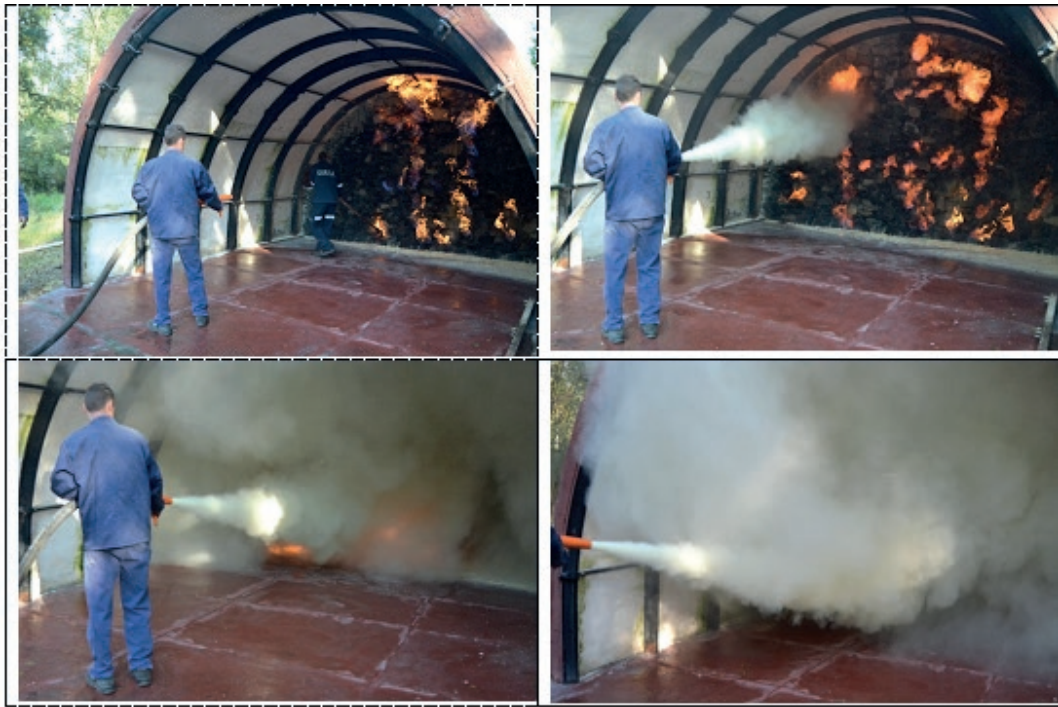
Рисунок 15 - Процесс объемного тушения горящего метана в опытном штреке при работе интегрированного модуля ИМОП (на базе осланцевателя MARS-H)
