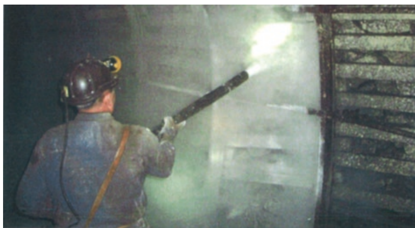
Рисунок 3 – Режим механического осланцевания горных выработок Figure 3 - Mechanical mode of alkalization of mine workings
