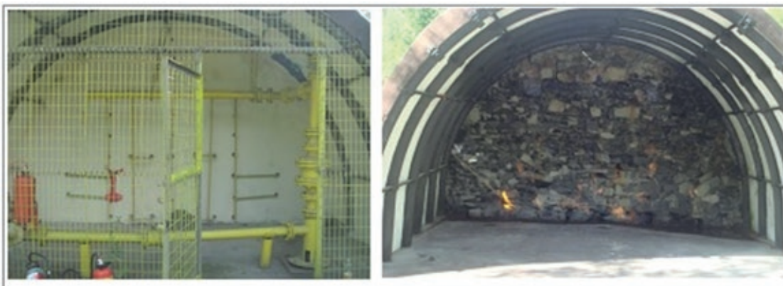
Рисунок 1 – Шахтный стенд для обучения горнорабочих методам борьбы с горением метана в выработках Figure 1 - Mine stand for training miners in methods of dealing with burning of methane in the workings
