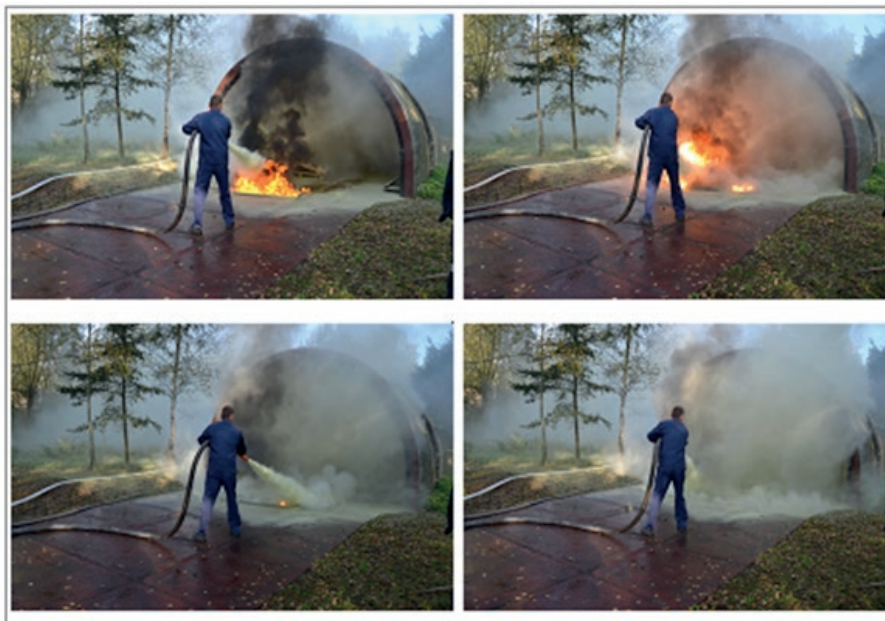
Рисунок 7 – Процесс тушения бензина модулем ИМОП Figure 7 - Gasoline extinguishing process by the IMOP module
