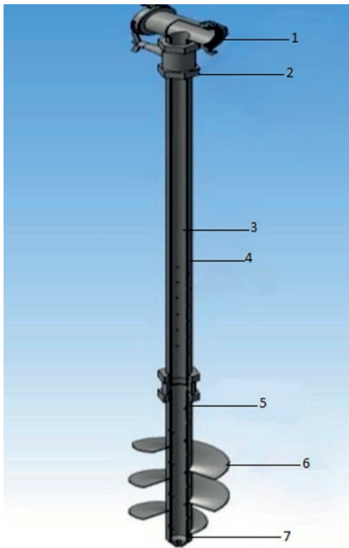
Рисунок 2. Торфяной пожарный ствол 1 - тройник; 2 - клапан регулятор давления; 3 - удлинительный ствол; 4 - отверстия; 5 - ствол; 6 - шнековые лопасти; 7 - нижнее отверстие
