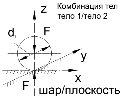
Рисунок 1 - Комбинация тел, тело 1/тело 2 (шарик и плоскость) Figure 1 - Combination of bodies, body 1 / body 2 (ball and plane)
