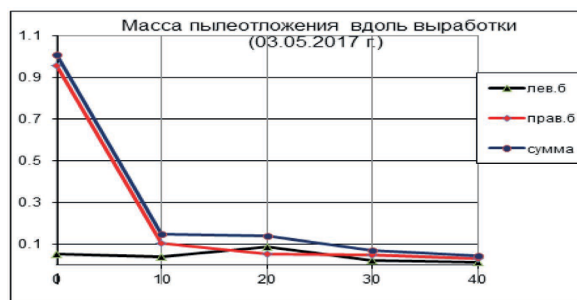
Рисунок 14 – Распределение измеренной массы пылеотложения (ось Y, граммы) на подложках вдоль выработки (ось X, метры) для измерений 03.05.2017 Figure 14 - Measured dust sedimentation mass distribution (axis Y, grams) on the plates along the opening (axis X, meters) for measurements on 03.05.2017
