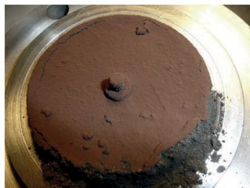
Рисунок 4 – Снимок частиц богатой руды, осевших после опыта на нижний фланец трубы Figure 4 – Picture of rich ore particles deposited after the experiment on the pipe lower flange
