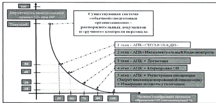
Рисунок 2 – График уменьшения вероятности неисполнения ПБ при ВР Figure 2 – The decrease in the probability of safety rules non-fulfillment at blast works graph
