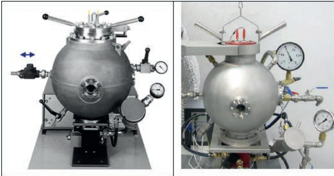
Рисунок 3 - Сферические взрывные камеры объемом 20 дм 3 (фото: Adolf Kühner AG, Швейцария – слева; ANKO, Польша - справа)
