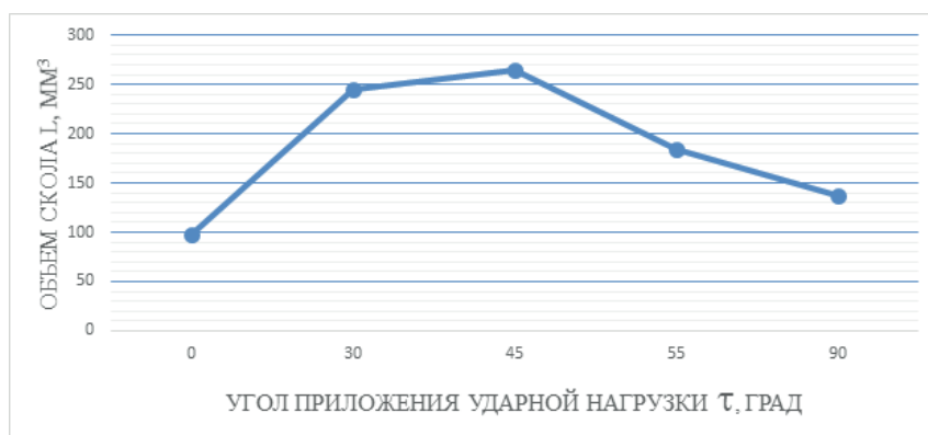
Рисунок 5 - График зависимости объема скола от угла приложения ударной нагрузки Рисунок 5 - График зависимости объема скола от угла приложения ударной нагрузки
