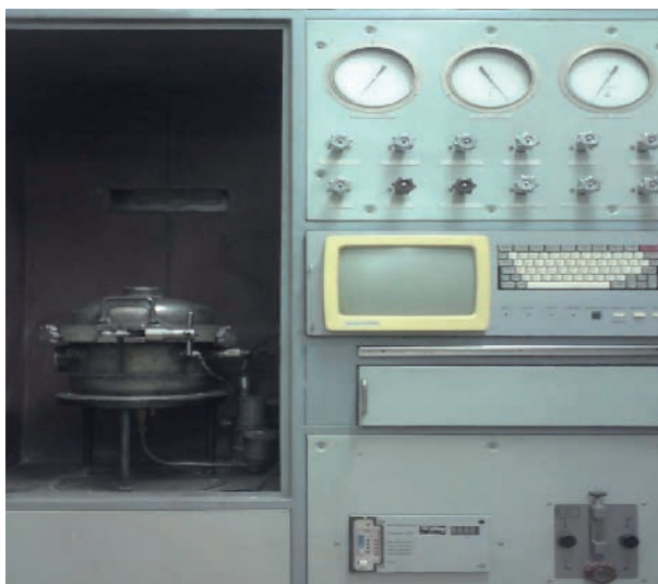
Рисунок 4 - Взрывная камера (объем 20 л) и аппаратно-программный исследовательский комплекс ФГБУ ВНИИПО МЧС России (ПВ20)
