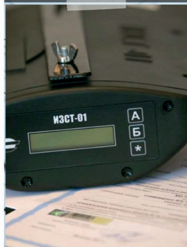
Стационарный датчик ИЗСТ-01 для контроля рабочей зоны
