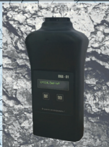
Переносной прибор контроля запыленности PKA-01
