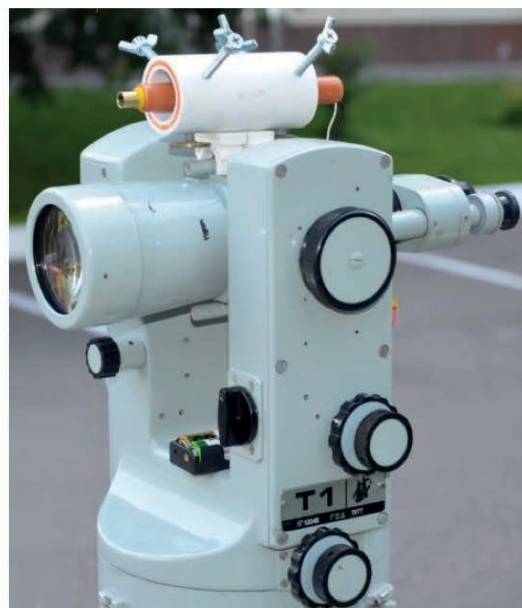
Рисунок 6 – Неподвижный маркер в виде светоприёмника и сверхточный теодолит T-1, совмещённый с юстируемым источником лазерного луча
