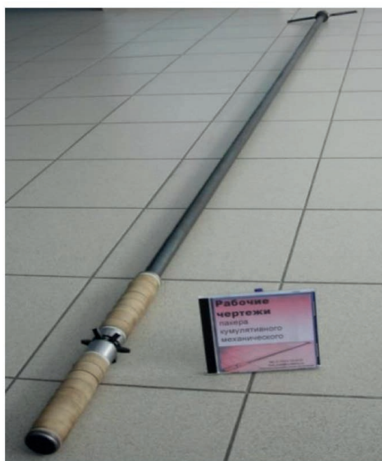
Рисунок 5 – Пакер манжетный механический (ИУ СО РАН)
