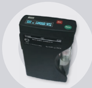
Прибор контроля пылевзрывобезопасности горных выработок ПКП
