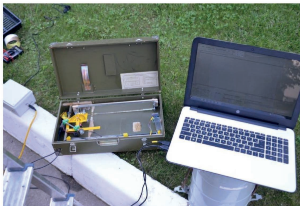
Рисунок 3 – Фотография ПНЭПИ-1 с выводом данных результатов измерений на персональный компьютер со специализированным программным обеспечением Figure 3 - PNEPI-1 photo with the conclusion of the given results of measurements on the personal computer with the specialized software
