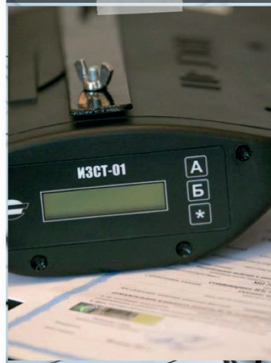
Стационарный датчик ИЗСТ-01 для контроля рабочей зоны
