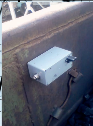
Стационарный датчик ИЗСТ-мини для контроля пылящих грузов в полувагонах
