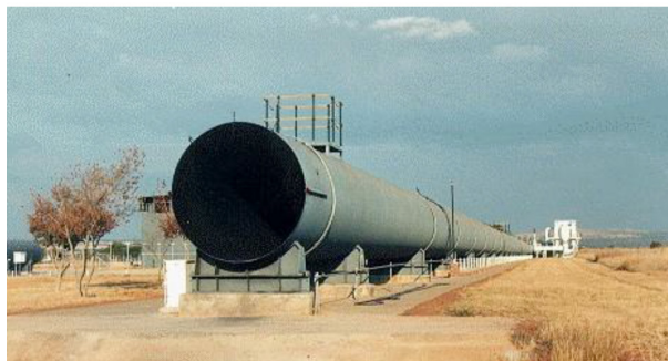
Рисунок 7 – Общий вид 200 метровой испытательной галереи CSIR, ЮАР (вид со стороны открытого в атмосферу портала; фото CSIR)
