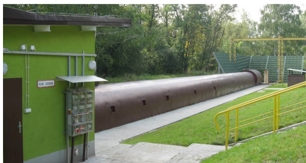
Рисунок 6 – Взрывная галерея КД «Барбара», длина - 44м (слева - центр управления; справа - открытый выход в атмосферу и шумо-пламегасители)
