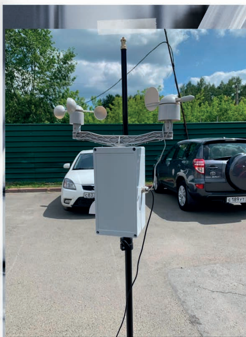
Внешний вид датчика с дополнительным модулем направления и силы ветра Установлены в Новокузнецке
