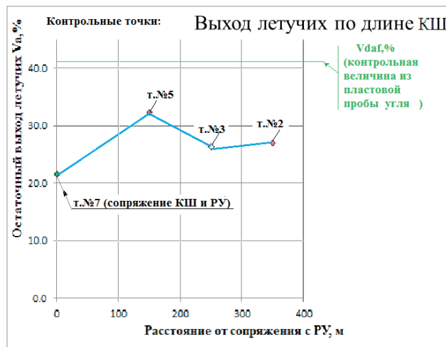
Рисунок 7 – Выход летучих веществ из пыли в конвейерном штреке (после поворота УВВ под углом ≈90° по ходу вентиляционной струи) Figure 7 - The volatile substances' emission from dust in the conveyor gallery (after ESW turning at an angle of ≈90° along the air stream)
