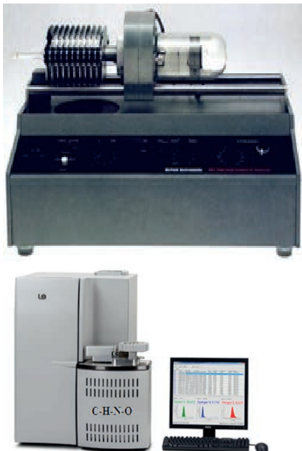
Рисунок 2 - Оборудование для термогравиметрического и газового анализа (вверху – для исследования 1 образца, внизу – до 16 образцов одновременно с распознаванием газов) Figure 2 - Equipment for thermogravimetric and gas analysis (on the left - to study 1 sample, on the right - up to 16 samples simultaneously with gas recognition)
