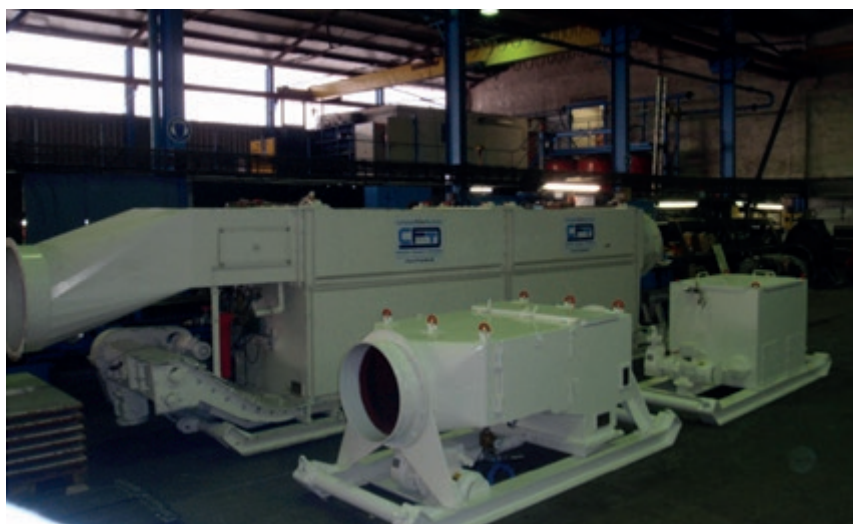
Рисунок 1 - Пылеуловители мокрого и сухого типов на примере продукции фирмы CFT GmbH, Германия (на переднем плане мокрый скруббер и далее – бак-накопитель шлама, на втором плане – пылеотсос сухого типа) Figure 1-wet and dry type dust Collectors on the example of products from CFT GmbH, Germany (in the foreground is a wet scrubber and then a sludge storage tank, in the background is a dry type dust pump)
