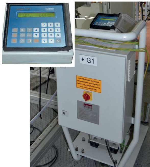
Рисунок 6 – Дифференциальный весовой дозатор DDB с цифровым блоком управления Figure 6 - Differential weight batcher DDB with digital control unit
