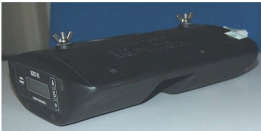
Рисунок 2 – Датчик ИЗСТ-01 на испытаниях Figure 2 - IZST-01 sensor during tests
