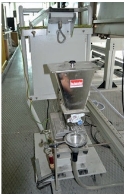
Рисунок 6 – Дифференциальный весовой дозатор DDB с цифровым блоком управления Figure 6 - Differential weight batcher DDB with digital control unit
