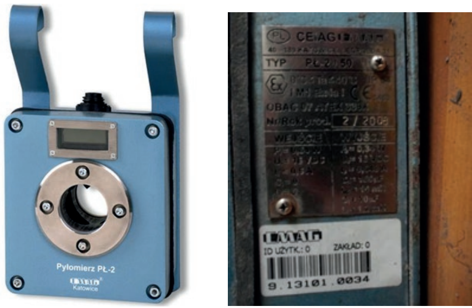
Рисунок 3 – Оптический пылемер PŁ-2 и заводская идентификационная табличка Figure 3 - Optical dust meter PŁ-2 and factory identification plate
