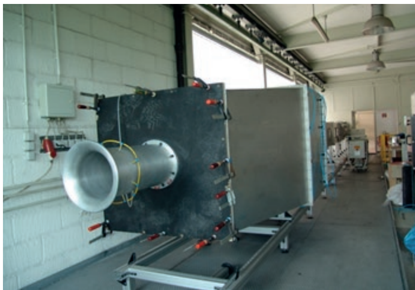
Рисунок 5 – Сертифицированное устройство определения скорости потока воздуха на входе испытательного стенда (слева) и стенд DBT по стандарту DIN EN 779 Figure 5 - Certified device for determining the air flow rate at the inlet of the test bench (left) and the DBT bench according to DIN EN 779
